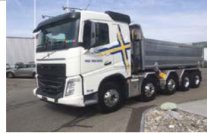
Volvo FH-540 10x4R (D11-17W) EZ 23.04.2018 ca.46'808 km, Trösch 3-Seitenkipper, VEB+, VDS, Crawler 1, Compact Retarder
