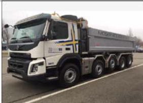
Volvo FMX-500 10x4R (D08-17Z)EZ 01.03.2018 ca. 49'853 km, 2-Seitenkipper Moser Rockbox 16.5m3, VDS, Crawler 2, Retarder
