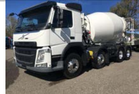
Volvo FM-460 8x4R Mischer (VTR99)Neufahrzeug ca.420 km, VEB+, Liebherr Fahrmischer, Light Line, Leergewicht 13'600 kg
