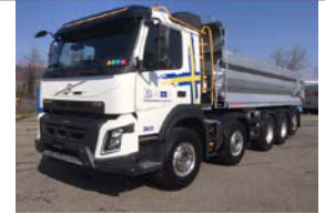
Volvo FMX-540 10x4R (D16-170) EZ 29.09.2017 ca. 33'981km, VEB+, VDS, Crawler 1, Radstand 4100 mm, Schwarzmüller Rückwärtskipper 16m3
