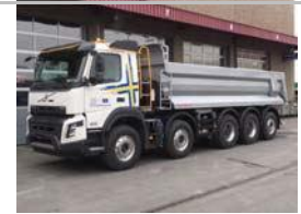
Volvo FMX-500 10x4R Kipper (D17-17Z)EZ 26.02.2018 ca.31'000km, VDS, Crawler 1, Radstand 4300mm, Schwarzmüller Rückwärtskipper 16m3
