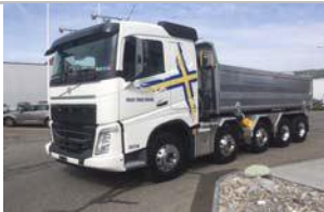
Volvo FH-540 10x4R (D11-17W) EZ 23.04.2018 ca.37'502km, Trösch 3-Seitenkipper, VEB+, VDS, Crawler 1, Compact Retarder
